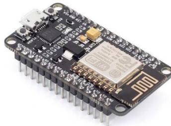
Figure 1.14 : NodeMCU (ESP8266) [39]
