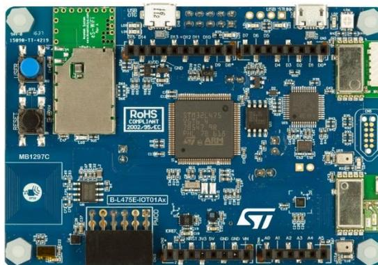
Figure 1. 16 : Nœud B-L475E-IOT01A [40]
