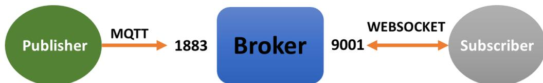
Figure 2.19 : Sub/Pub entre Websocket et MQTT
