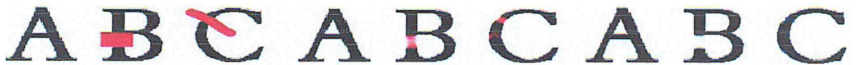
Figure 6.9 : Limites de l'inpainting pour un masque plus large que l'épaisseur des traits
