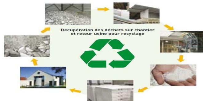
Figure II.26: Le cercle du recyclage du béton cellulaire [20]
