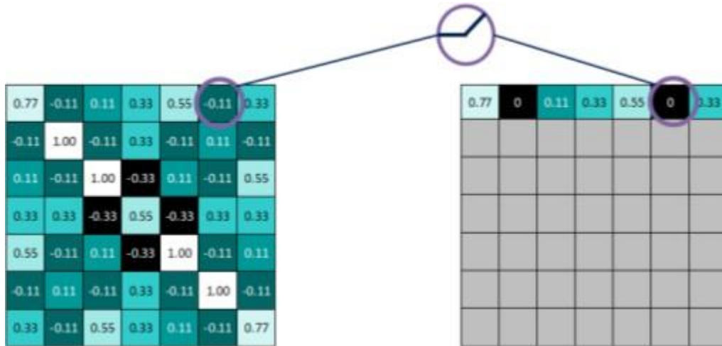
Figure 3.6 : Exemple d'application de la fonction Relu sur une image [35]
