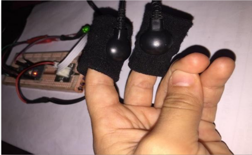
Figure 2.1. Les électrodes et leurs emplacements
