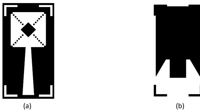
Figure 4.3. Typons de l'antenne 3 à réaliser, (a) Face avant (Elément rayonnant), (b) Face arrière (Plan de masse).
