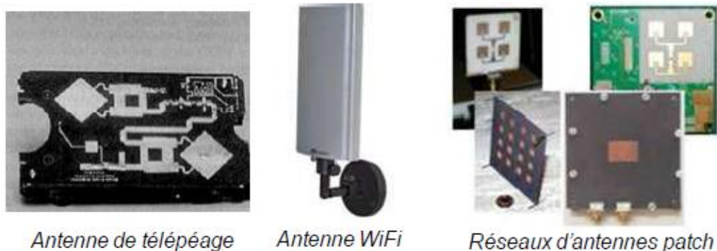
Figure 1.9. Exemple d'antennes patch [1].
