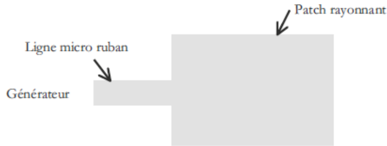
Figure 1.12. Alimentation par ligne imprimée (technologie microruban) [7].
