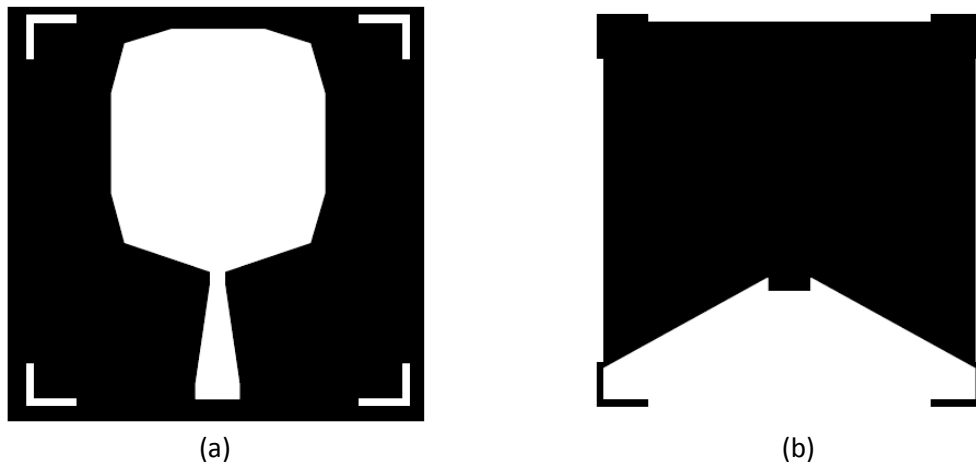
Figure 4.1. Typons de l'antenne 1 à réaliser, (a) Face avant (Elément rayonnant), (b) Face arrière (Plan de masse).
