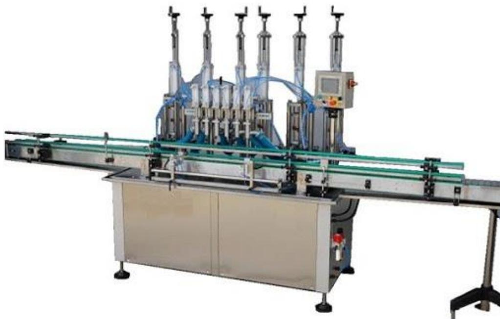
**Figure I.1** Machine de remplissage automatique.
