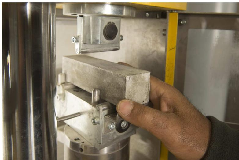
**Figure II.11:** Mesure de la résistance à la traction par flexion
