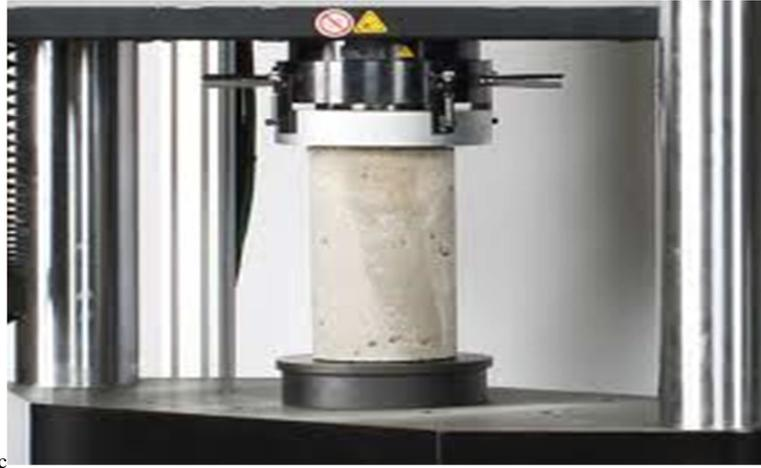
**Figure II.10:** Mesure de la résistance à la compression.
