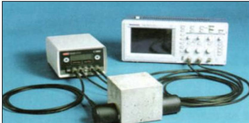
**Figure II.15:** Appareil d'auscultation sonore 58-E48 avec oscilloscop
