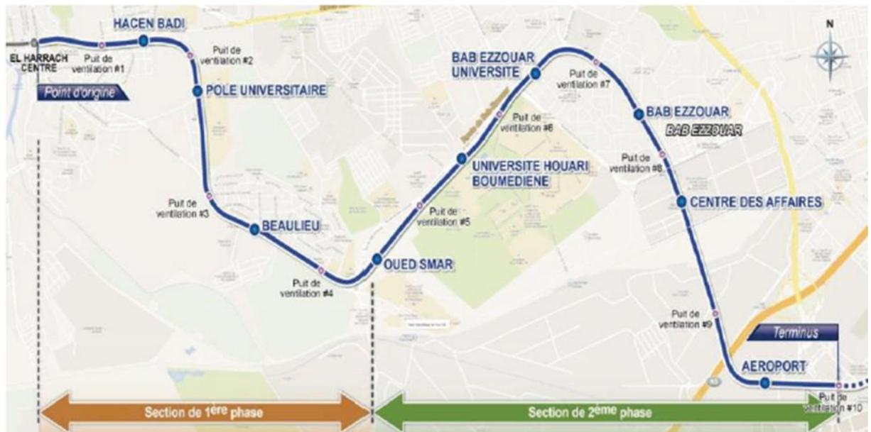
**Figure I.2.** Tracé de l'extension du métro El Harach – Aéroport international
