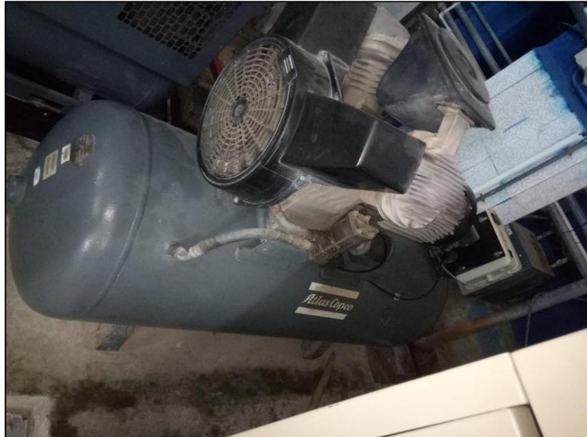
*Figure 2-13 : Compresseur d'air à haute pression.*
