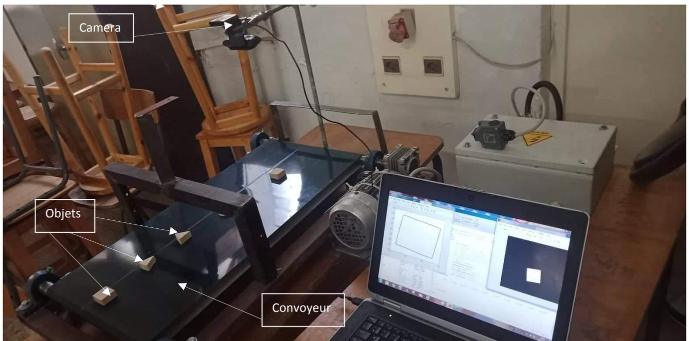
**Figure3.1** Système de détection poursuite et comptage d'objets par caméra placée au dessus du convoyeur.
