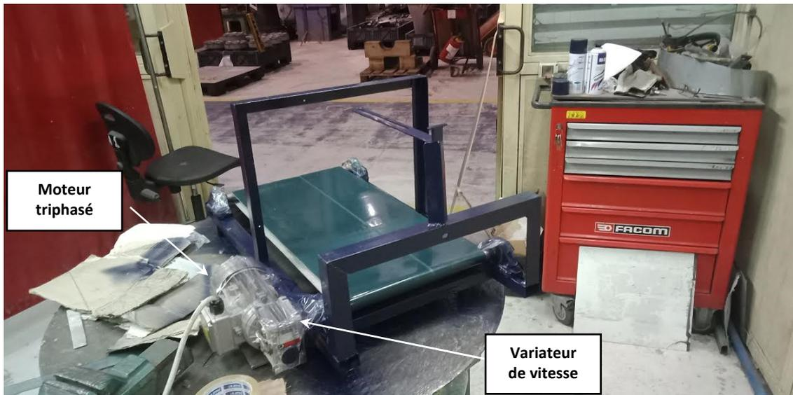
Figure 3.4 Convoyeur réalisé.
