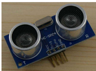
Figure 2.30: Capteur NodeMCU HC-SR04
