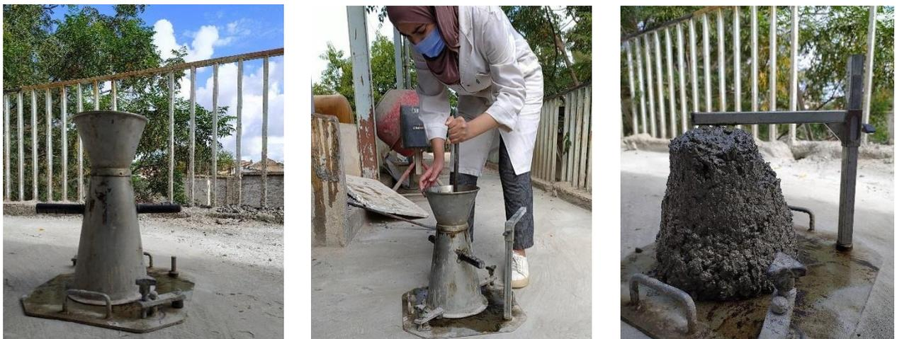
**Figure III.16 : L'essai d'Affaissement au cône d'Abrahams.**
