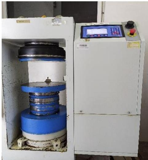
Figure III.27 : Machine de compression.
