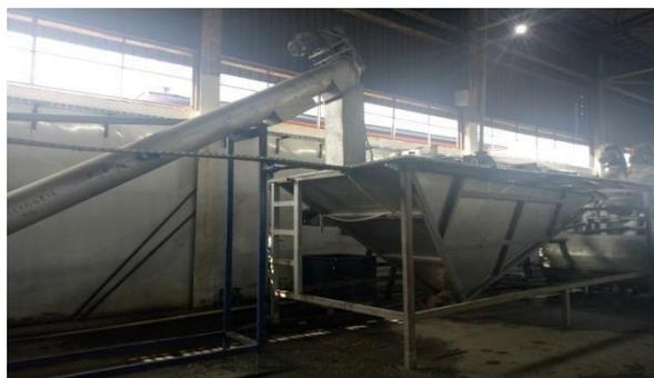
**Figure II.7 : Vis alimentation de machine de recyclage en EPWG.**
