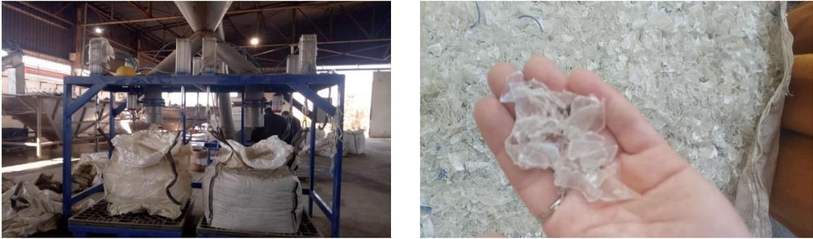
Figure II.11 : Stockage de déchet plastique et leur forme après le recyclage.
