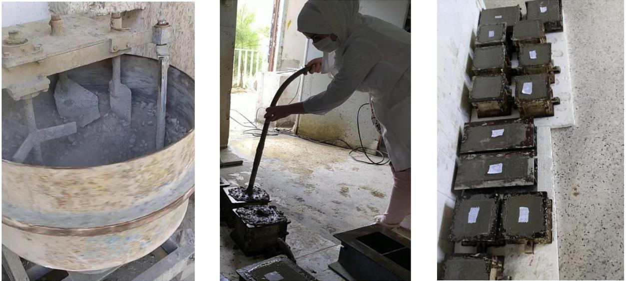
**Figure III.20 : Confection des éprouvettes.**
