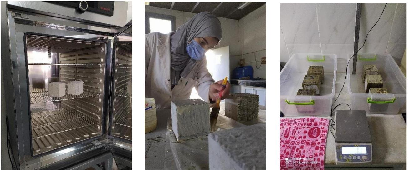
Figure III.31 : L'essai d'absorption d'eau.
