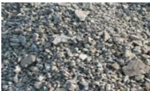
**Figure I.7 : Laitier de haut-fourneau cristallisé [3].**
