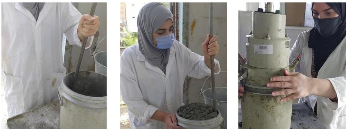
**Figure III.18 : Réalisation d'essai (air occlus ).**
