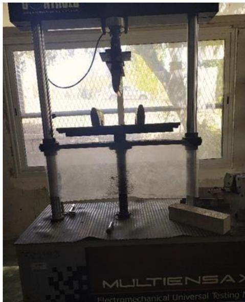
Figure III.29 : Machine de traction par flexion.
