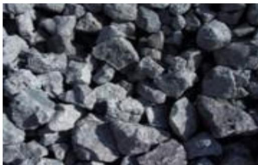
Figure I.9 : Laitier d'aciérie de conversion [5].
