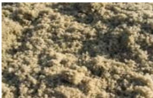
**Figure I.8 : Laitier de haut-Fouereau vitrifié (granulé ou bouleté) [5].**
