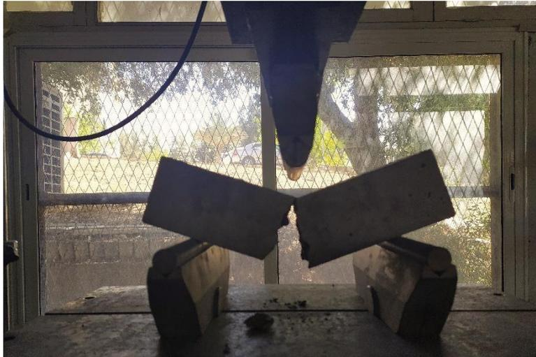
Figure III.30 : Essai de traction par flexion.
