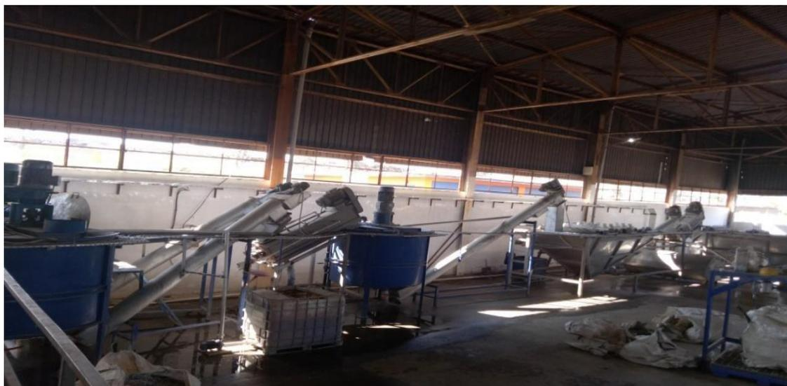
**Figure II.9 : Mélangeur machine de lavage de déchets plastique en EPWG.**
