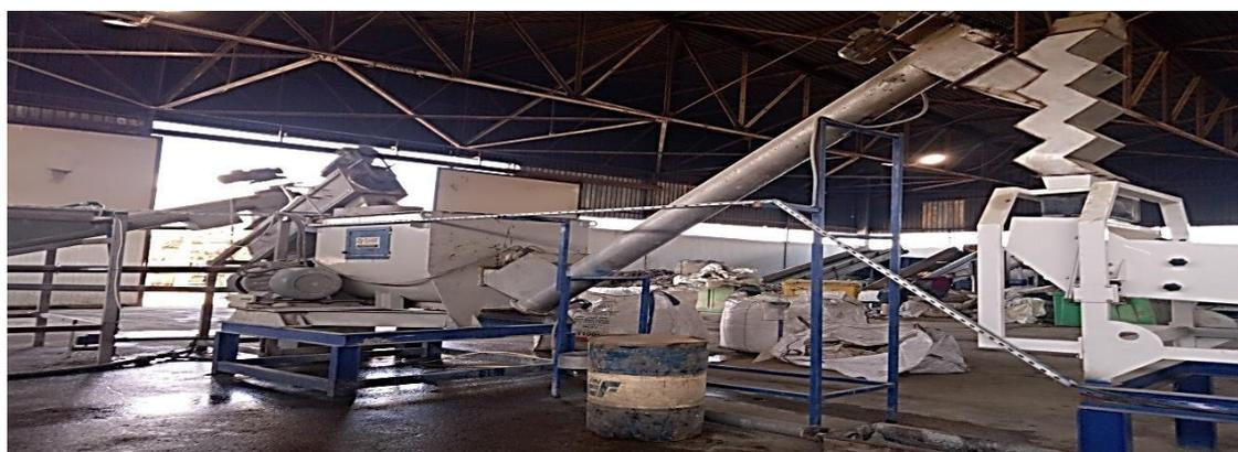
**Figure II.10 : Machine de séchage de déchet plastique en EPWG.**
