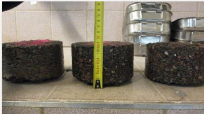
Figure I.31 : 3 carottages réalisés sur les 3 points de déflexion.
