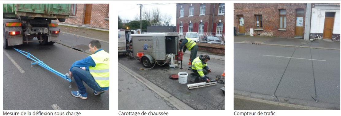
Figure I.28 : le dimensionnement structurel .
