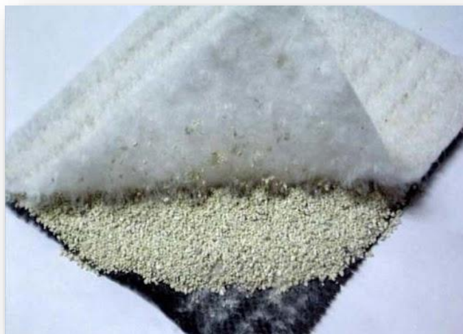
Figure I.41 : exemple de géosynthétique bentonitique.
