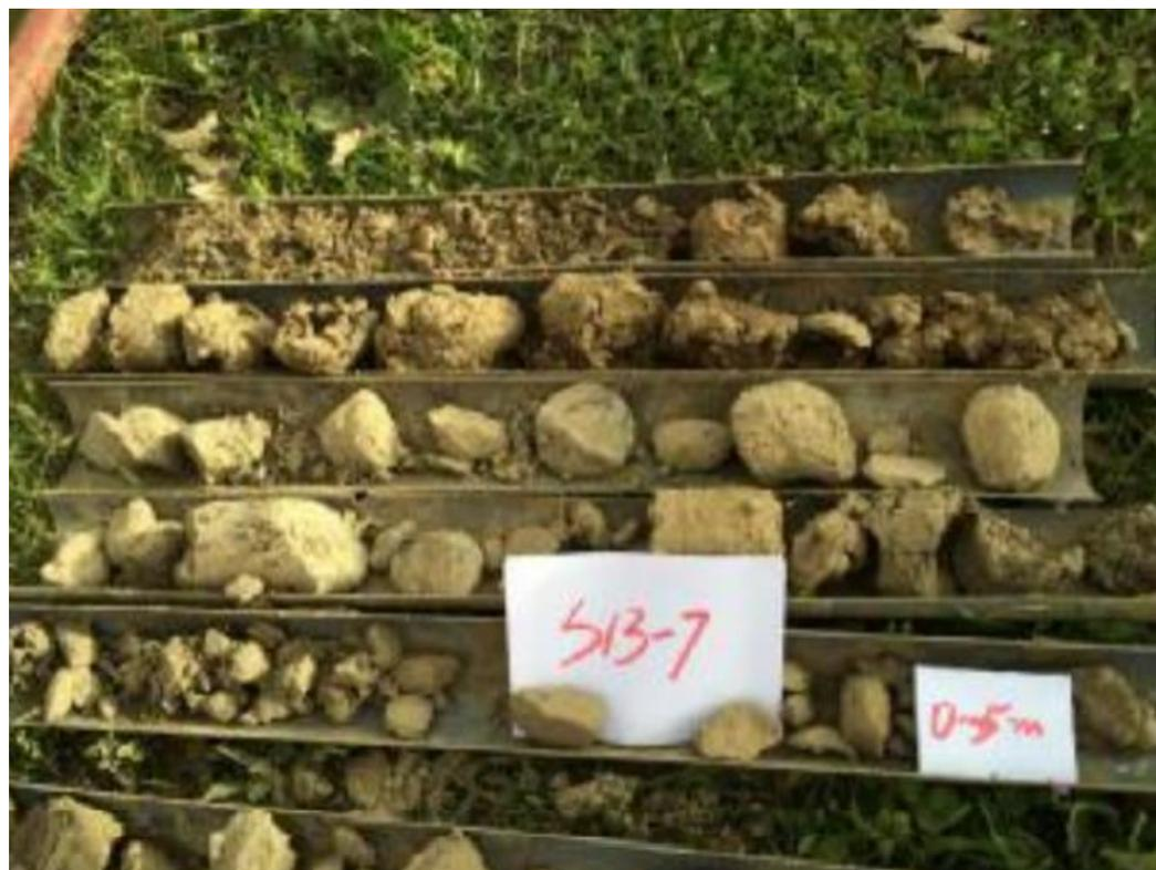
Figure 2.12 : remblai artificielle et cailloux.
