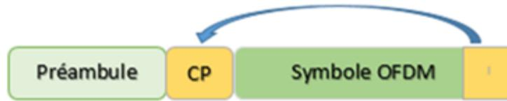
Figure 2.8 : Insertion du Préambule dans l’OFDM (Méthode de MOOSE)
