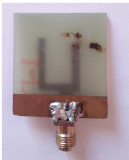
**Figure 3.4 :** Plan de masse partiel des deux antennes
