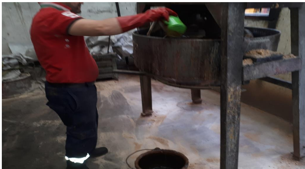
Figure I-14 : ouvrier faisant le dosage des constituants du sable
