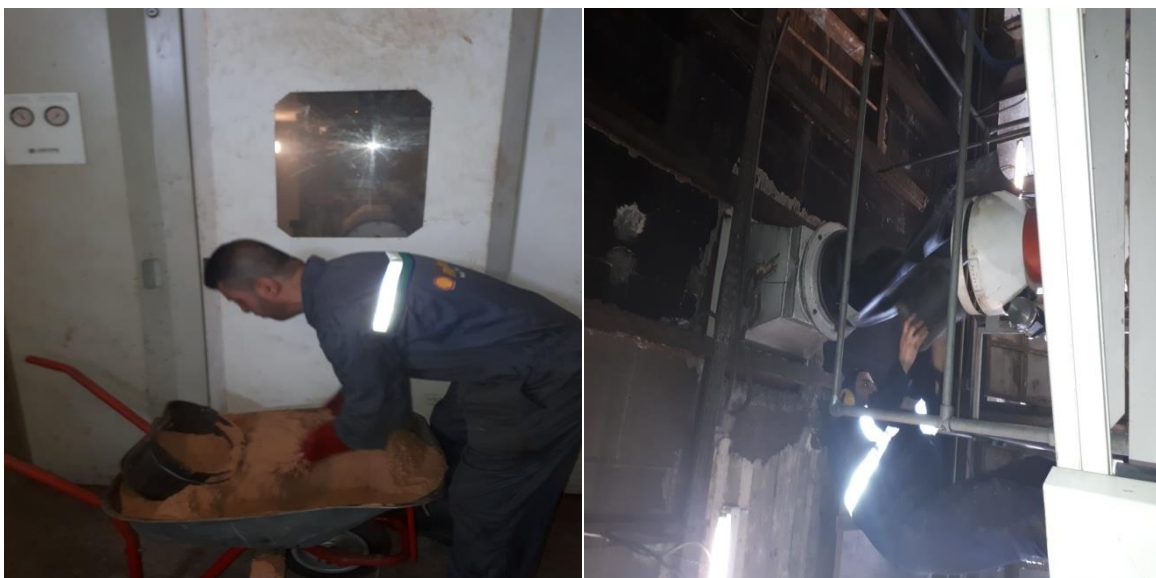
Figure I-17 : ouvrier remplir le sable dans la machine noyaux
