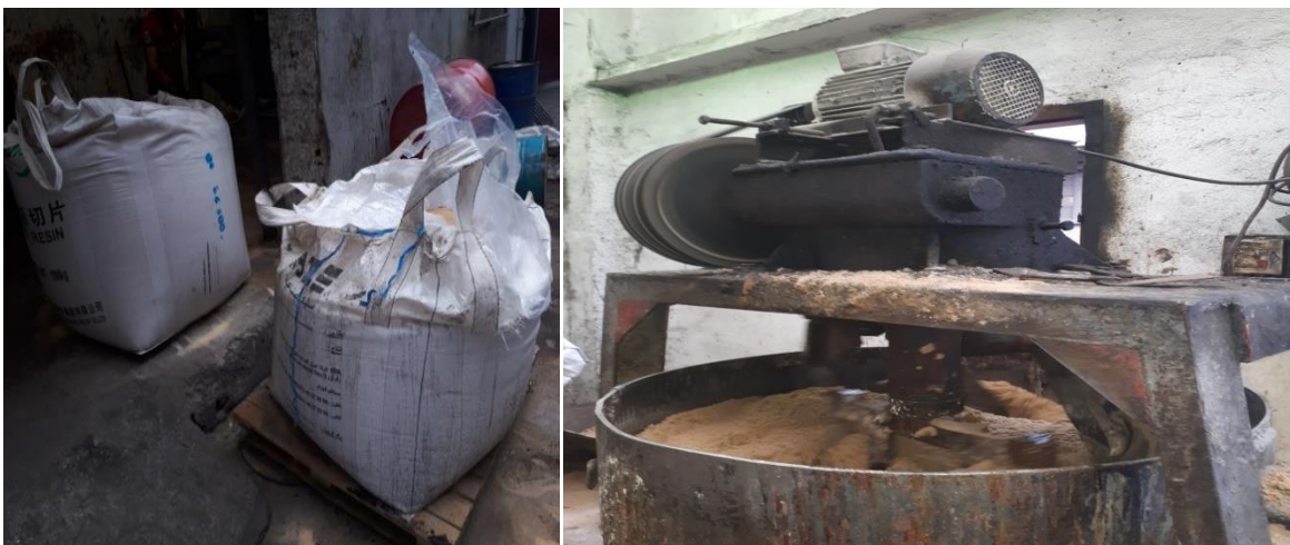
Figure I-12 : sable en sac Figure I-13 : malaxeur type broyeur
