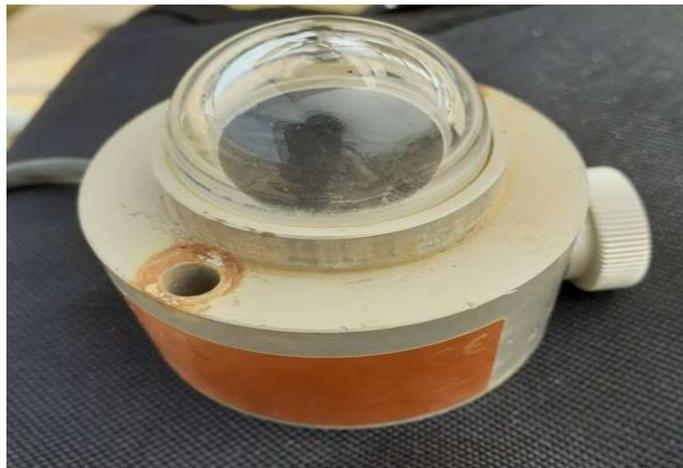
**Figure 2.6.** Pyranomètre.
