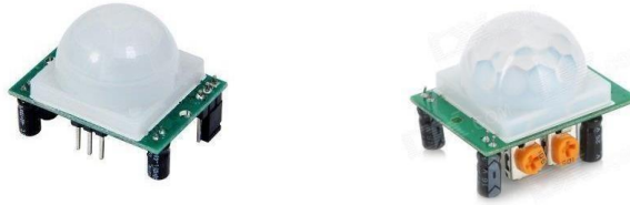
Figure 2.21 : Module détecteur de présence ou de mouvement PIR HC- SR501
