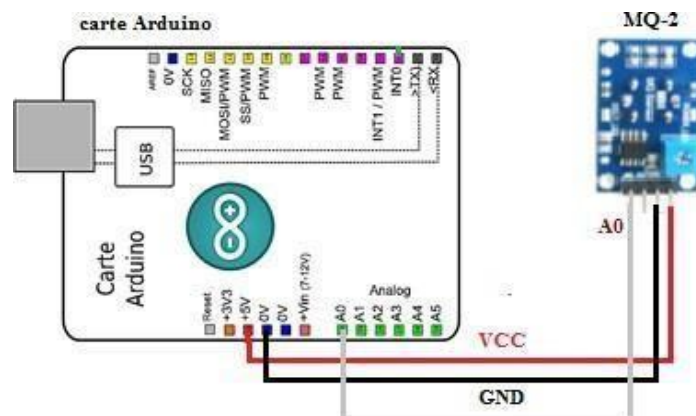
Figure 2.20 : Branchement du MQ-2 avec la carte Arduino
