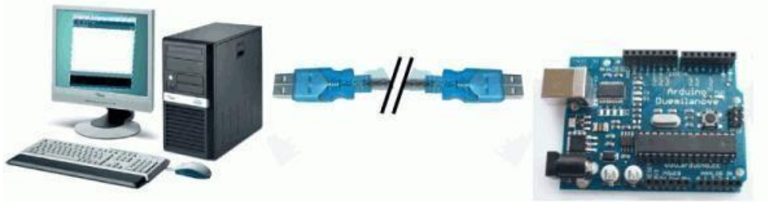
Figure 2.53 : Téléversement du programme sous EDI vers la carte Arduino
