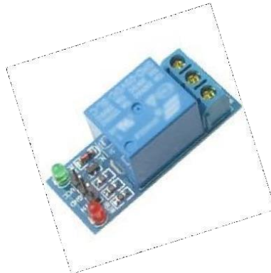
Figure 2.30 : Module relais 5V 1 canal 220V 10A
