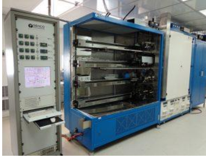
Figure.2.3 : Réacteur Plasma PECVD du CRTSE-Alger.
