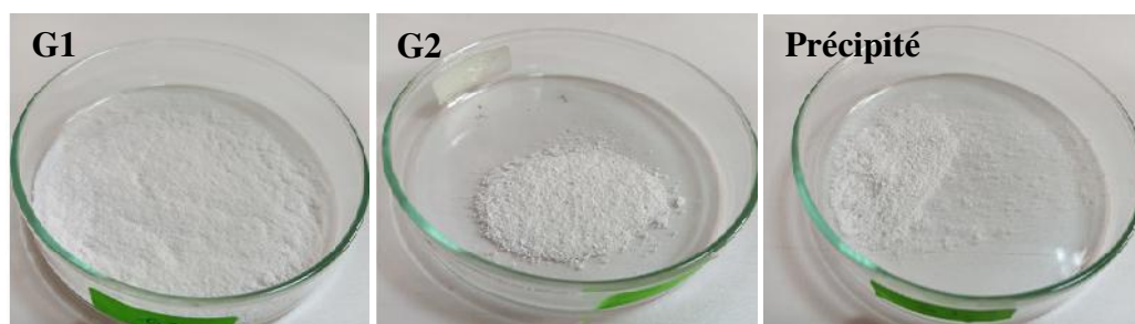
Figure 4.12 : Gel de silice après séchage classique .
