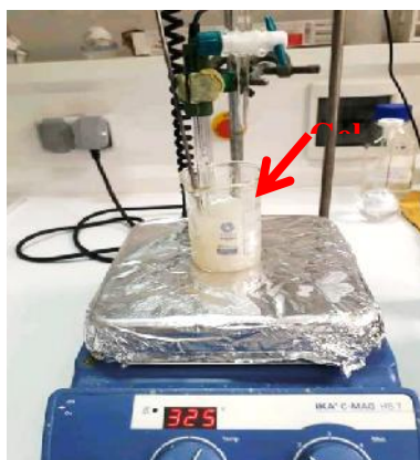
Figure 4.9 : Formation de gel et précipité de silice (hydrolyse + condensation).
