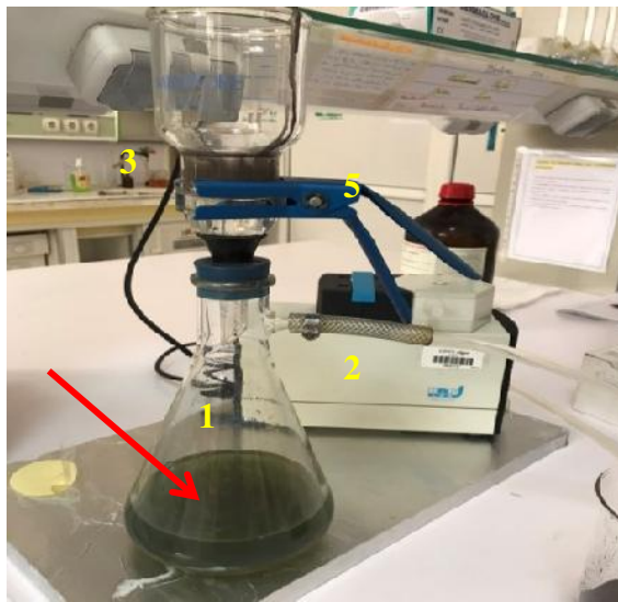
Figure 4.4 : Filtration sous vide après lavage acide par HCl.
