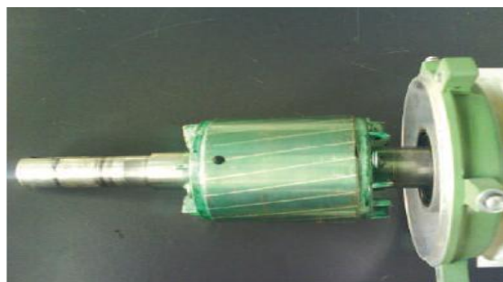
Figure 1.8. Rupture de barre rotorique.
