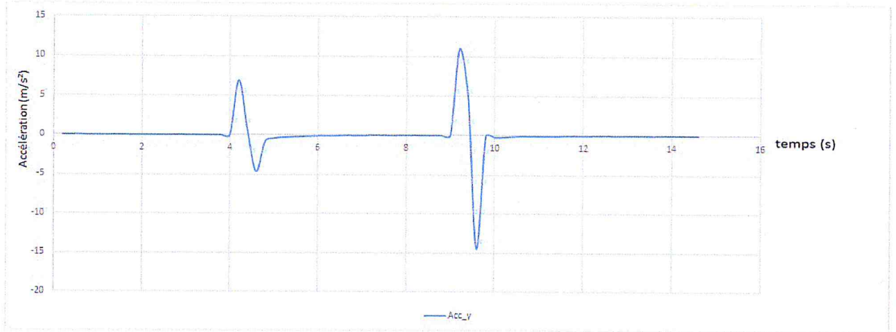
FIGURE 2.18: Graphe de l'accélération finale de l'axe Y avec l'utilisation des filtres sur la plateforme
