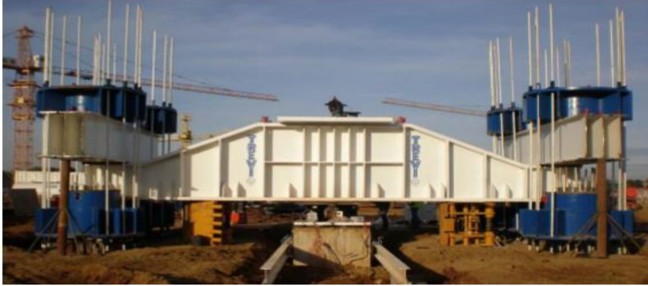
Figure.1.5 : Essai de chargement vertical d'un pieu. [7]
