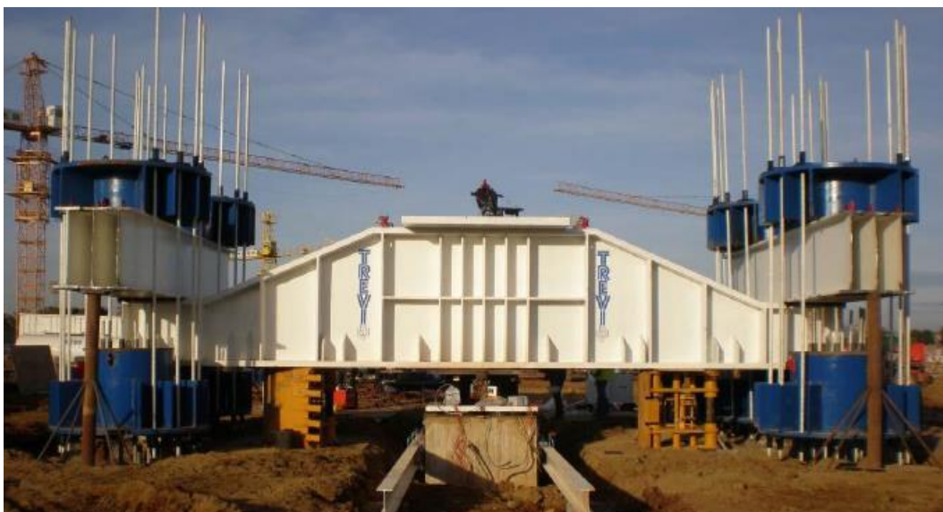
Figure 5.1 : Photo d'une configuration d'essai de chargement vertical. [18]
