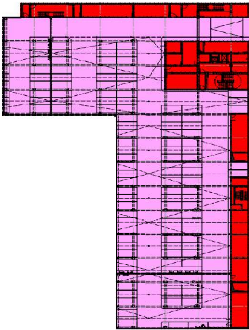
Charge permanente dans le deuxième sous-sol
