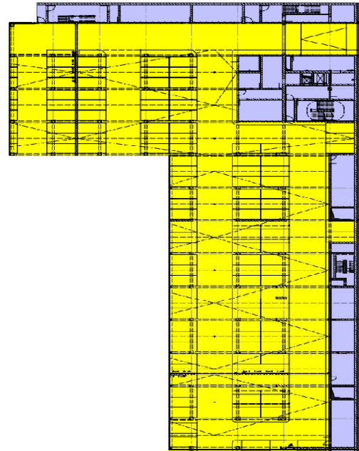
Charge d'exploitation dans le deuxième sous-sol
