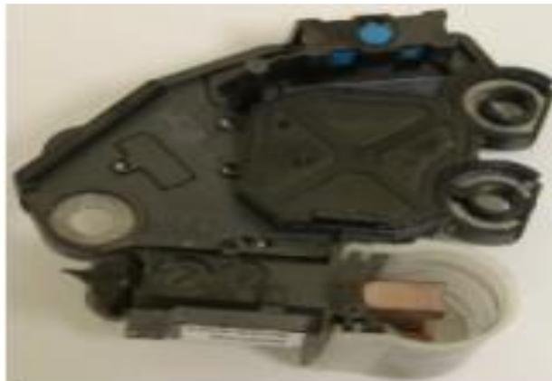
**Figure 1.7.** Régulateur de l'alternateur
