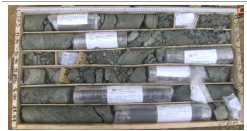
Figure 3.4 : La formation marneuse rencontrée au droit du sondage SC 1-1
