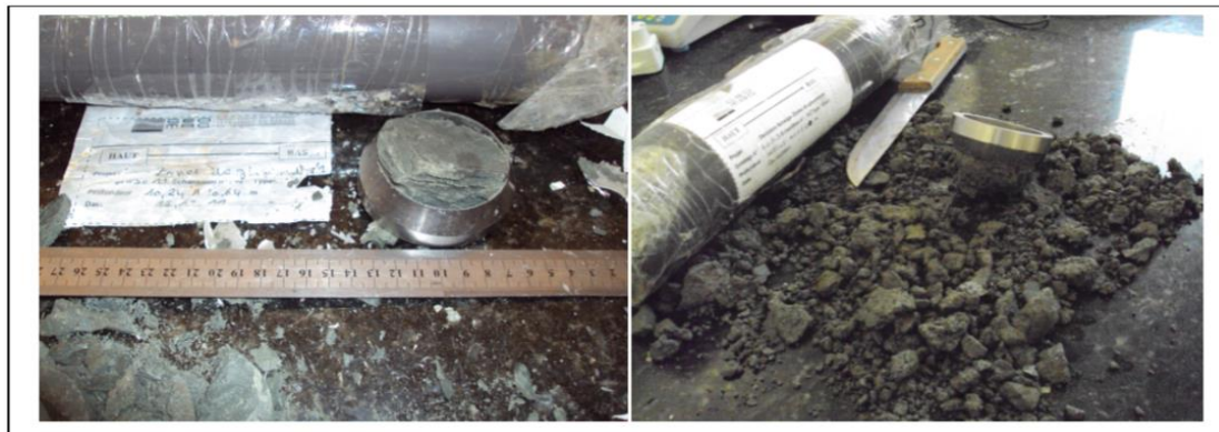
Figure 3.6 : Confection des éprouvettes pour l'essai de cisaillement rectiligne
