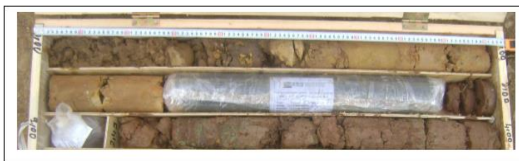
Figure 3.1: Argile gravelo-caillouteuse recoupée par le sondage SC 1-2
