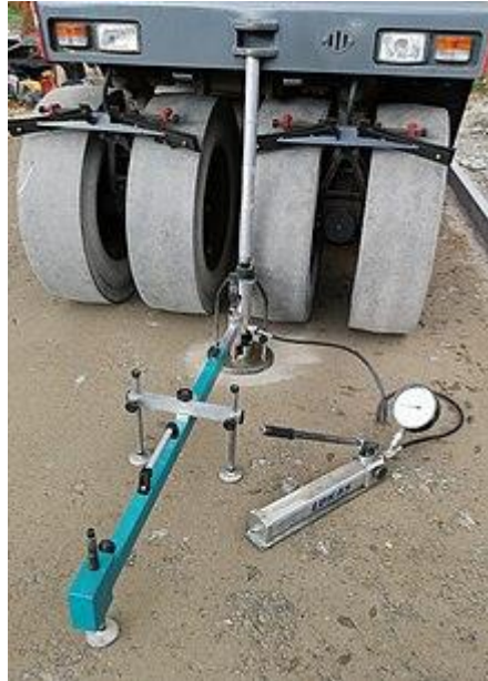
Fig.I.4 : Essai de charge sur plaque avec un rouleau packer à pneus de 15-20 tonnes pour contreponds
