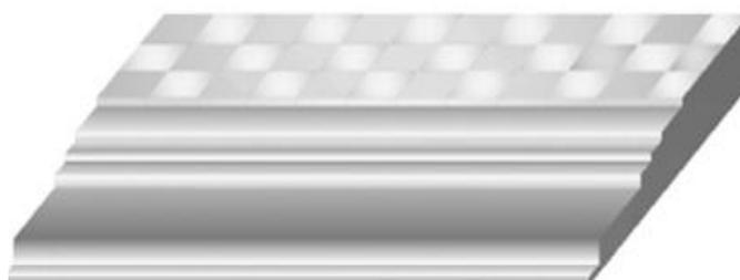
**Figure (II.9). Plancher en dalle pleine
