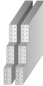
**Figure (II.10). Mur extérieur à double cloison**
