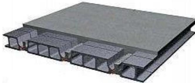
**Figure (II.2) : plancher à corps creux**
