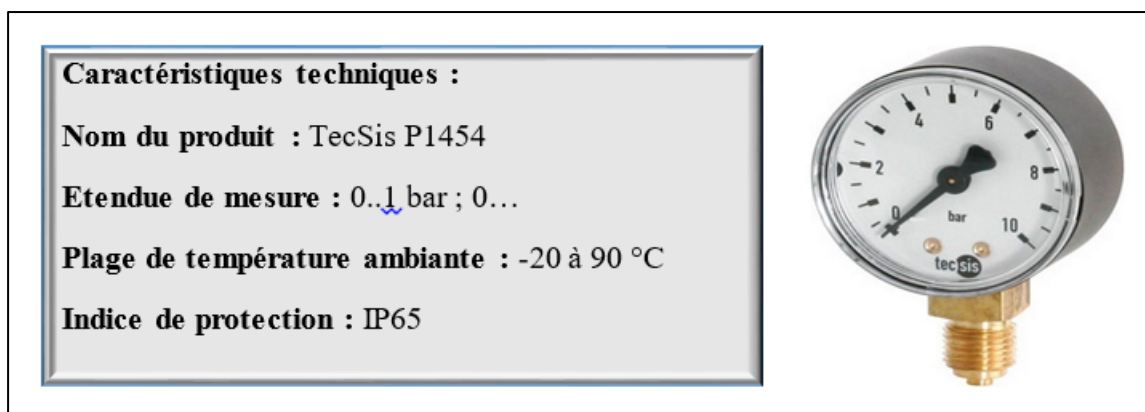
Figure 2.5 : Manomètre TecSis P1454 .
