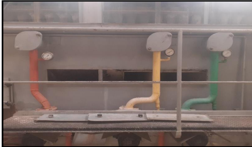
Figure 1.8 : Les trois bains de la machine.
