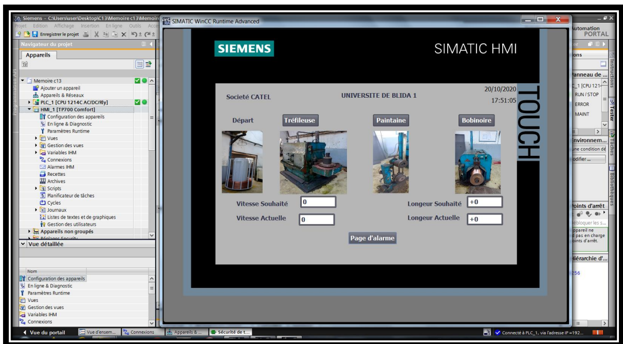
Figure. 3.25: Indication de la mise en ligne du programme et HMI.
