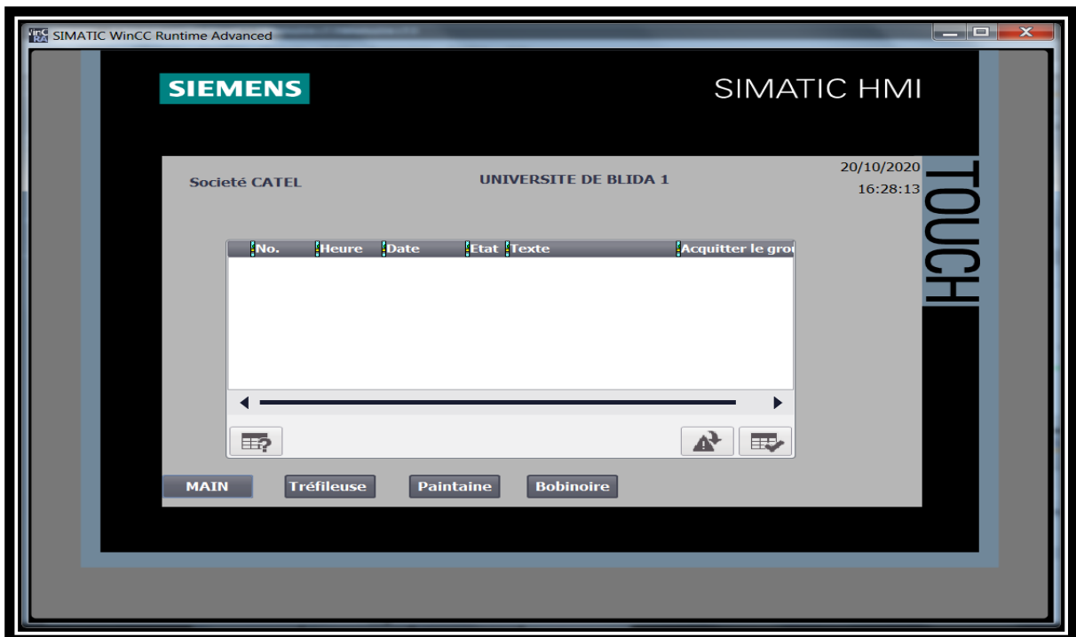
Figure. 3.34: Vue alarme du projet.
