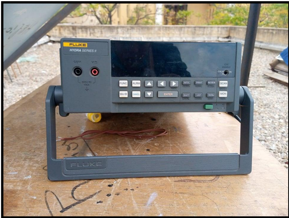
Figure 2.12 : D'acquisition de type FLUKE Hydra Séries
