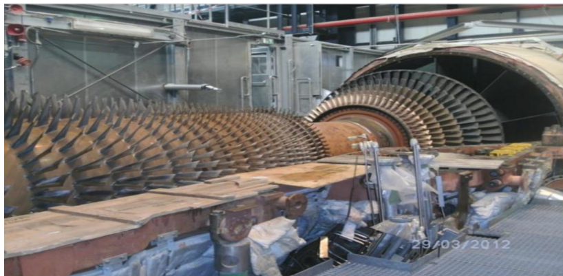
Figure I-21 : Le rotor du compresseur et de la turbine sur le même arbre
