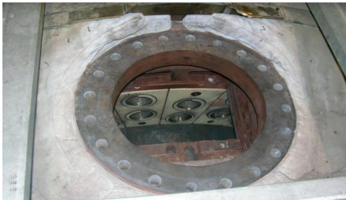
Figure I-19 : Vue l'emplacement des brûleurs à travers un trou de visite
