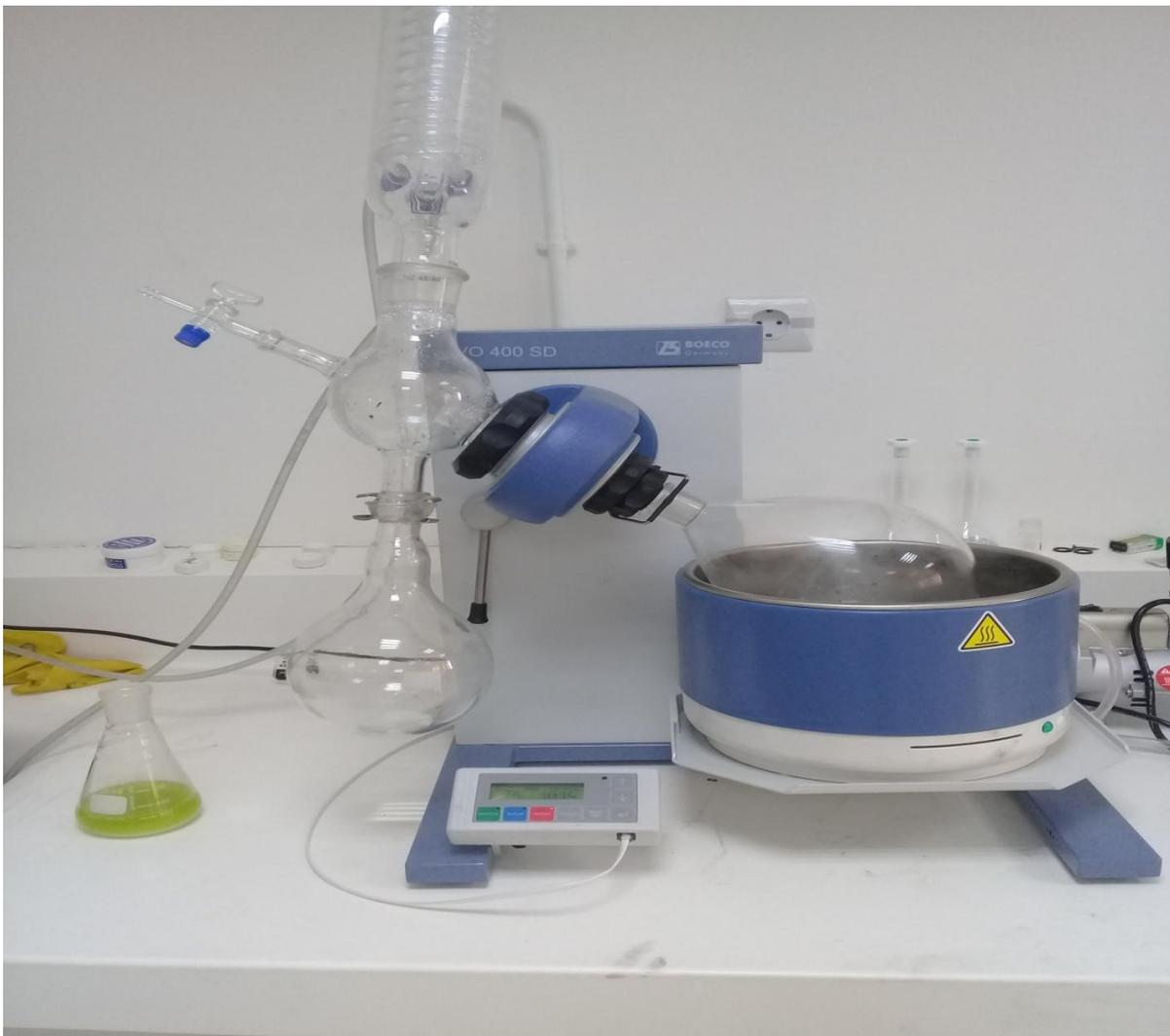
**Figure 20 :** photo de l'évaporateur rotatif BOECO Germany RVO 400SD (**Photo originale, 2019**).
