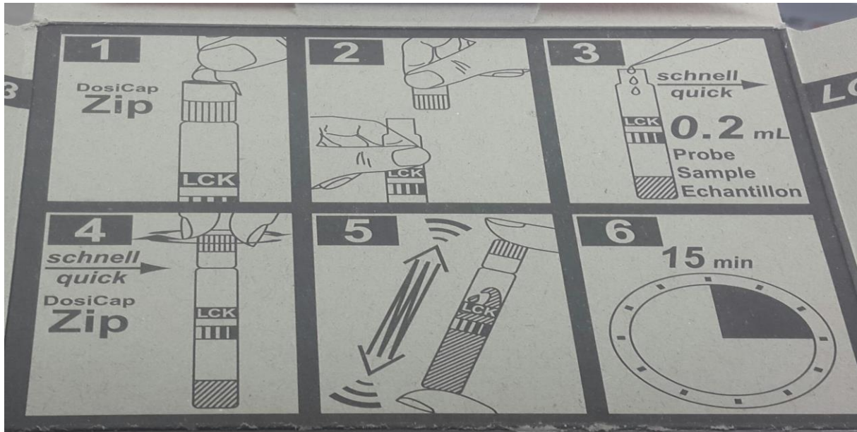
Fig 30 : Dosage de l'azote ammoniacal par la méthode kit Hach
