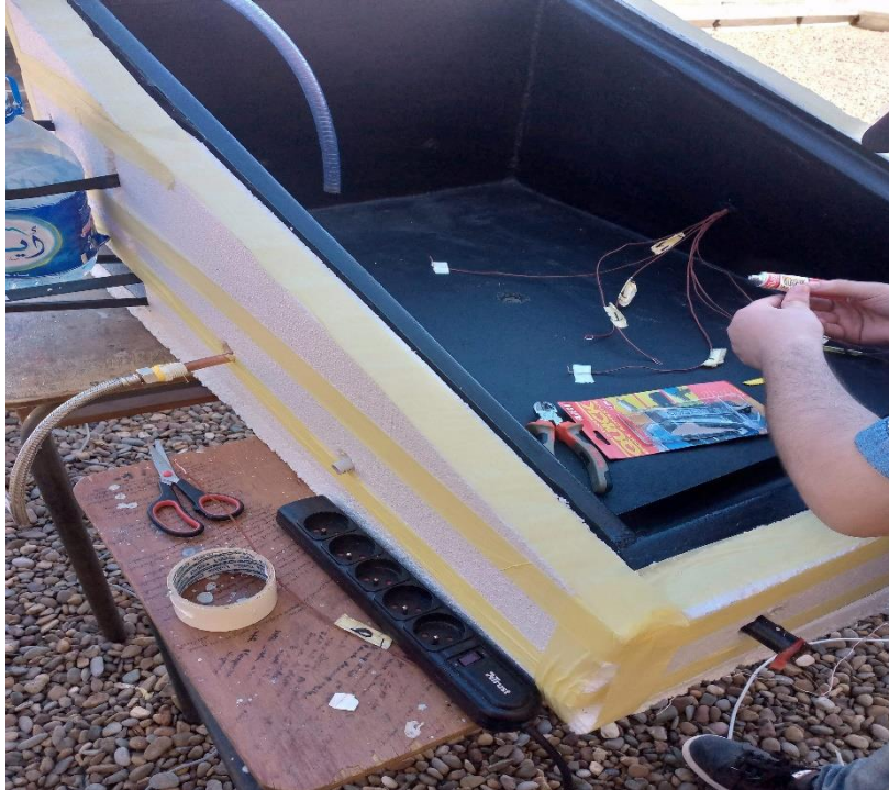
Figure 3.11 : Photo montre l'emplacement des thermocouples
