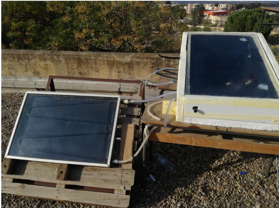
Figure 3.5: photos du système (distillateur-captteur) réalisé
