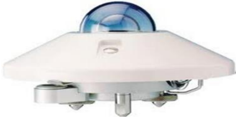
Fig. 2-7 : Pyranomètre pour la mesure de l'éclairement global horizontal
