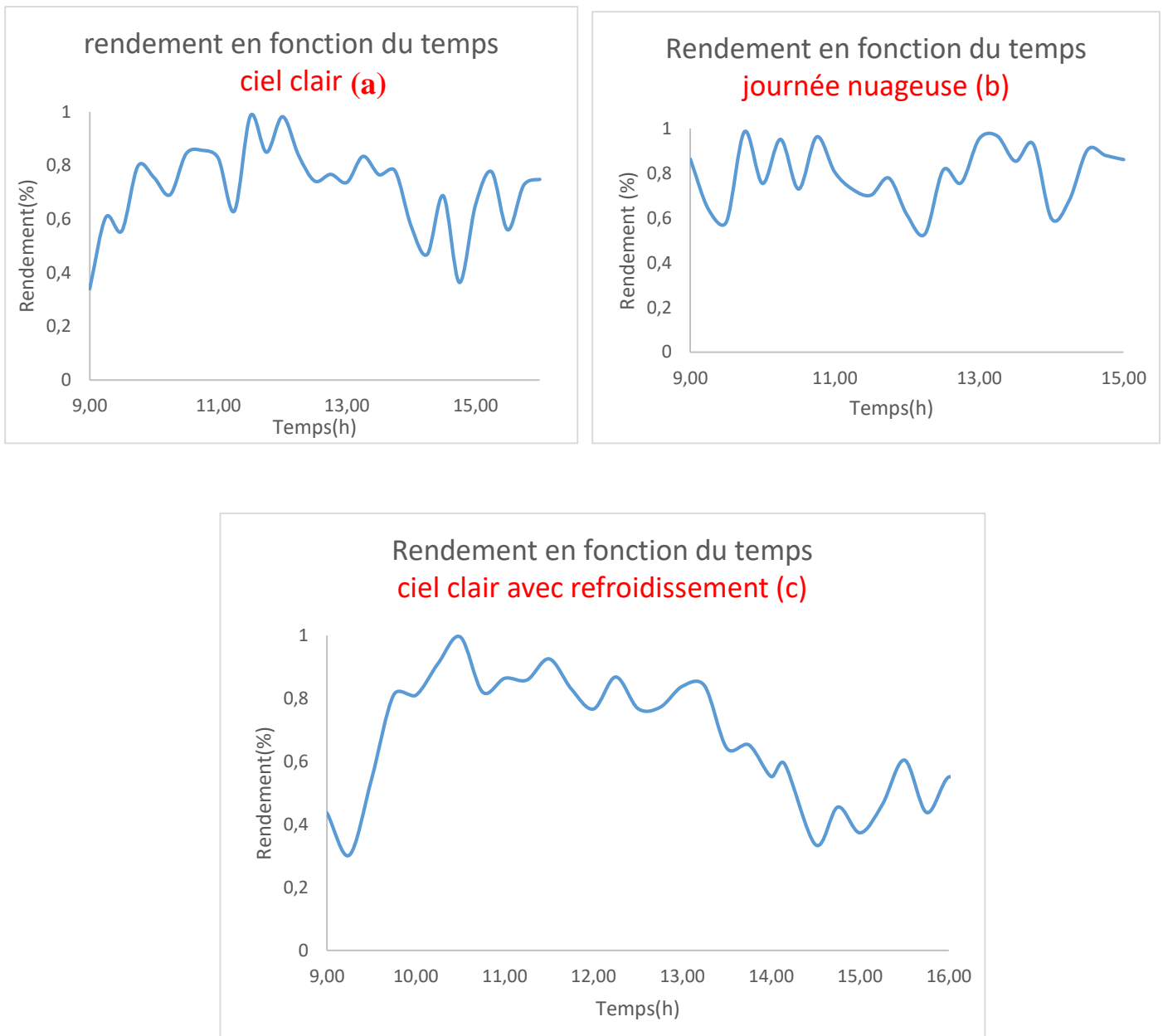
Figure 3.18 : Variation temporelle du rendement du capteur solaire
