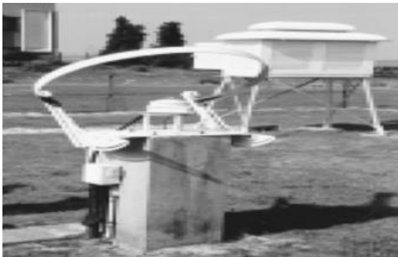
Fig. 2-6 : Diffusomètre pour la mesure de l'éclairement diffus.
