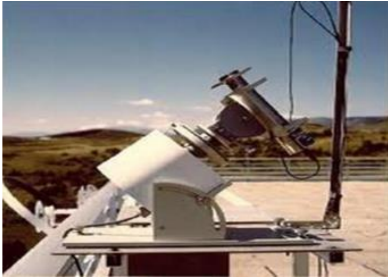
Fig. 2-5 : Pyrhéliomètre pour la mesure de l'éclairement directe.
