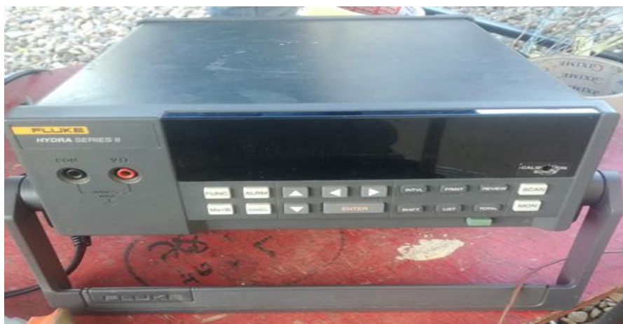
Figure 3.9 : Photo de l'acquisition des thermocouples.
