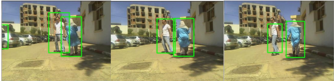
Figure III-45 : Application du détecteur de HOG sur les exemples de base Vid_ext 4
