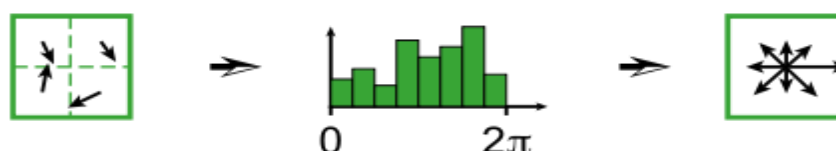
Figure II-14 : Orientation d'histogrammes de gradient
