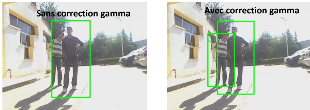
Figure III-35 : Résultat de détection sans et avec correction gamma
