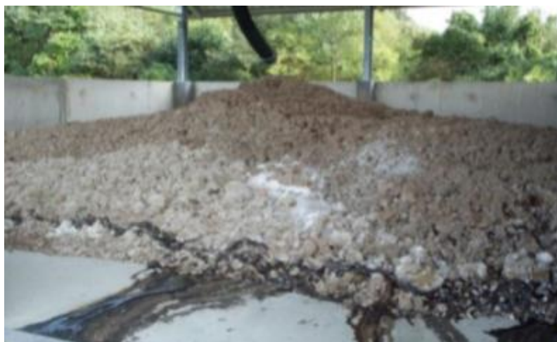
Figure 2.2 : Boues obtenues par traitement physico –chimique [41].
