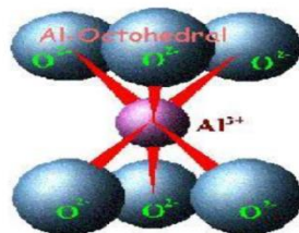
Figure I.6 : Structure des couches octaédrique et tétraédrique [21]
