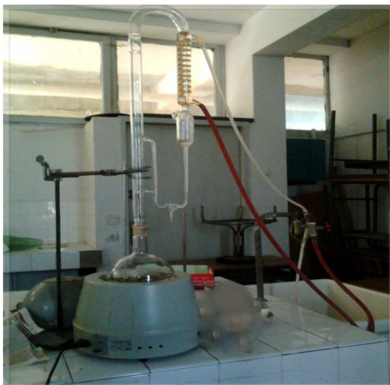
Figure 17 : Dispositif d'extraction par hydrodistillation du type clevenger (Originale, 2014)
