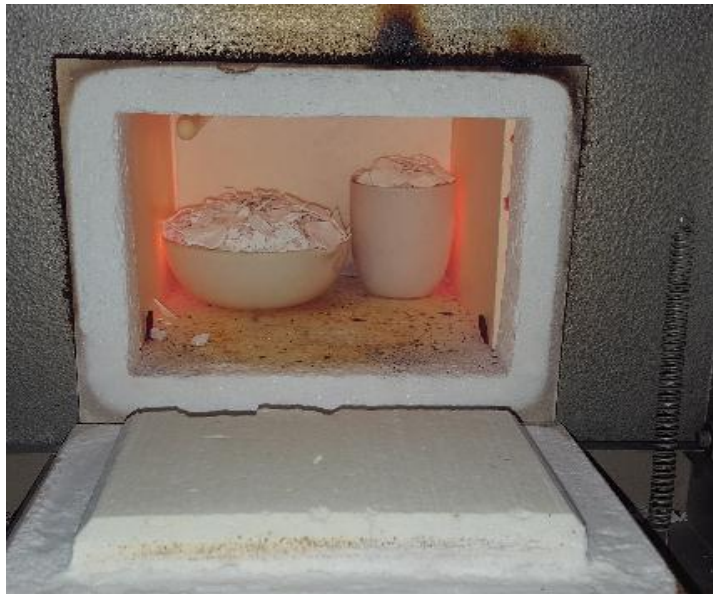
Figure 3.1 : l'étape de calcination de poudre.
