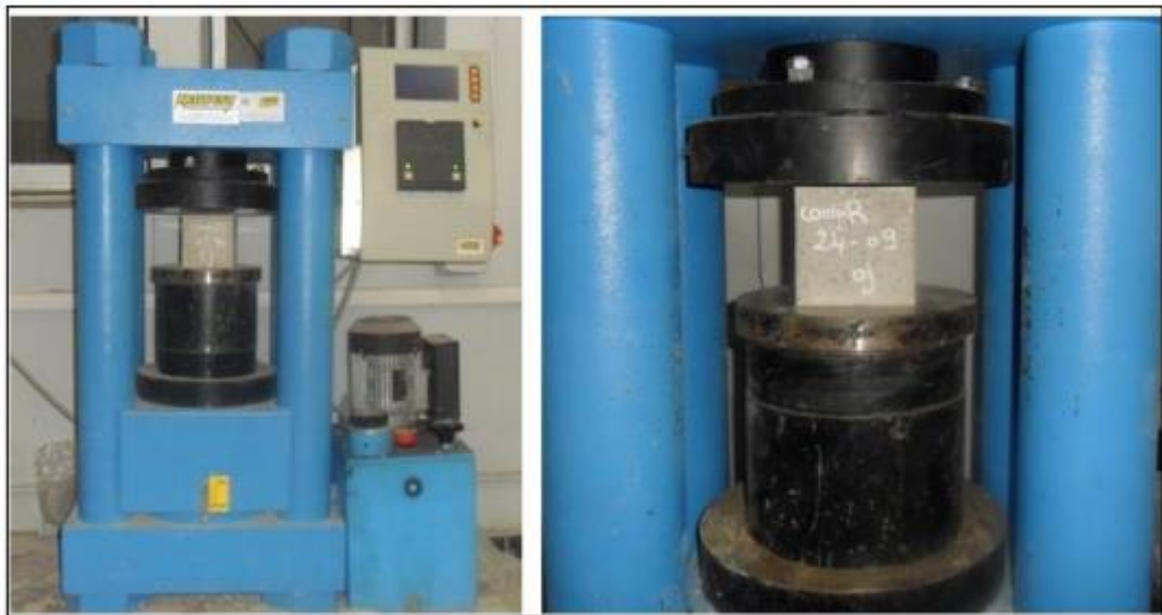
Figure 3-8 : Dispositif de l'essai de compression simple. [82]
