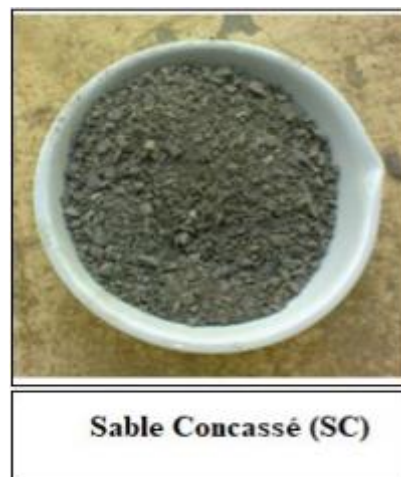
Figure 3-1 : texture et forme des particules du sable de concassage. [38]
