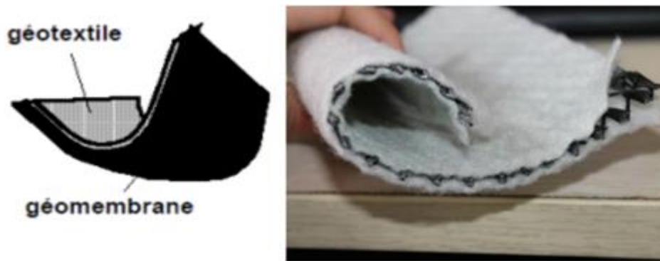
Figure 3.7: la structure d'un géocomposite.
