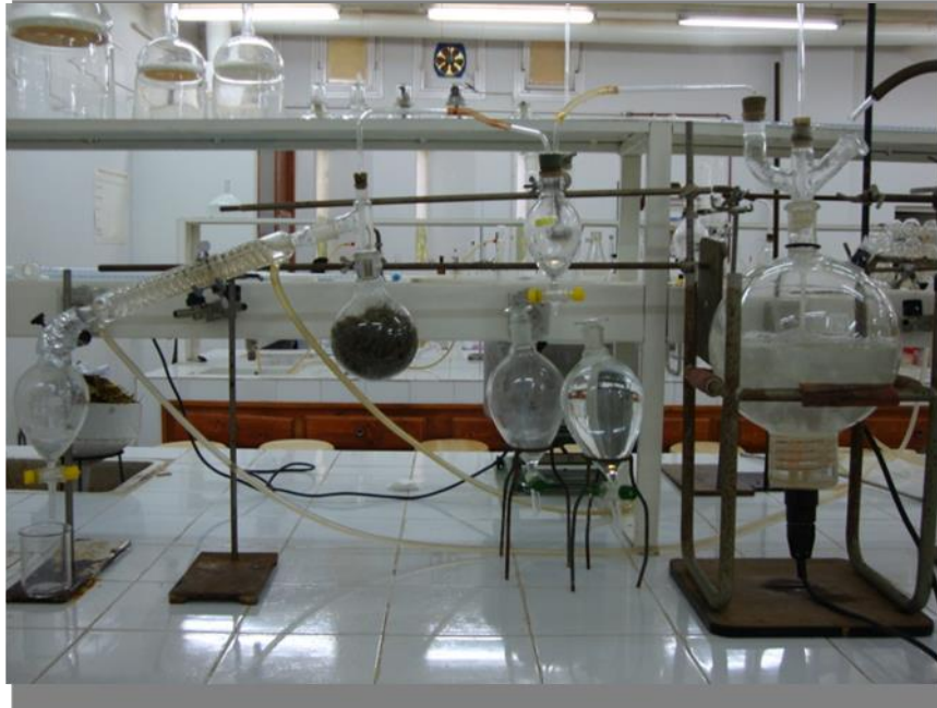
Le montage de l'entraînement à la vapeur d'eau.
