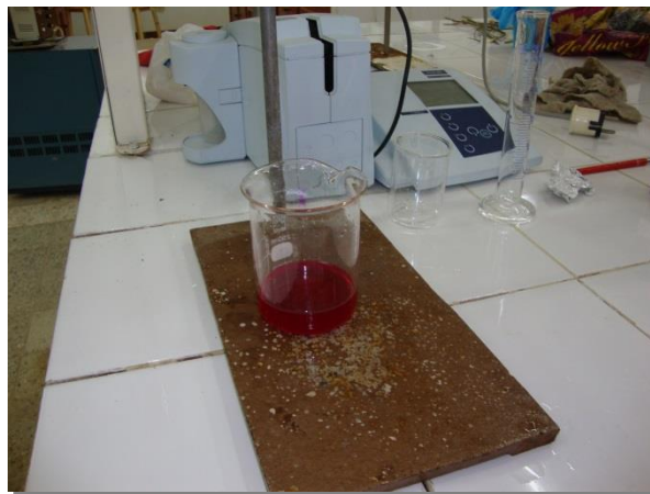
Le titrage de l'excès d'hydroxyde de potassium avec une solution d'acide chlorhydrique.
