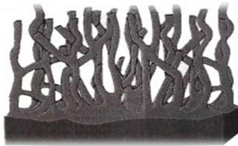
Figure 1.8 : Coupe schématique d'une couche de silicium poreux sur un substrat de silicium monocristallin. [25]
