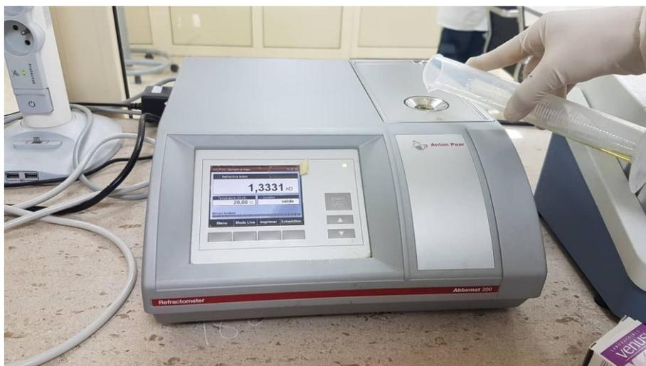
**Figure 2.12 :** mesure de l'indice de réfraction dans un réfractomètre.
