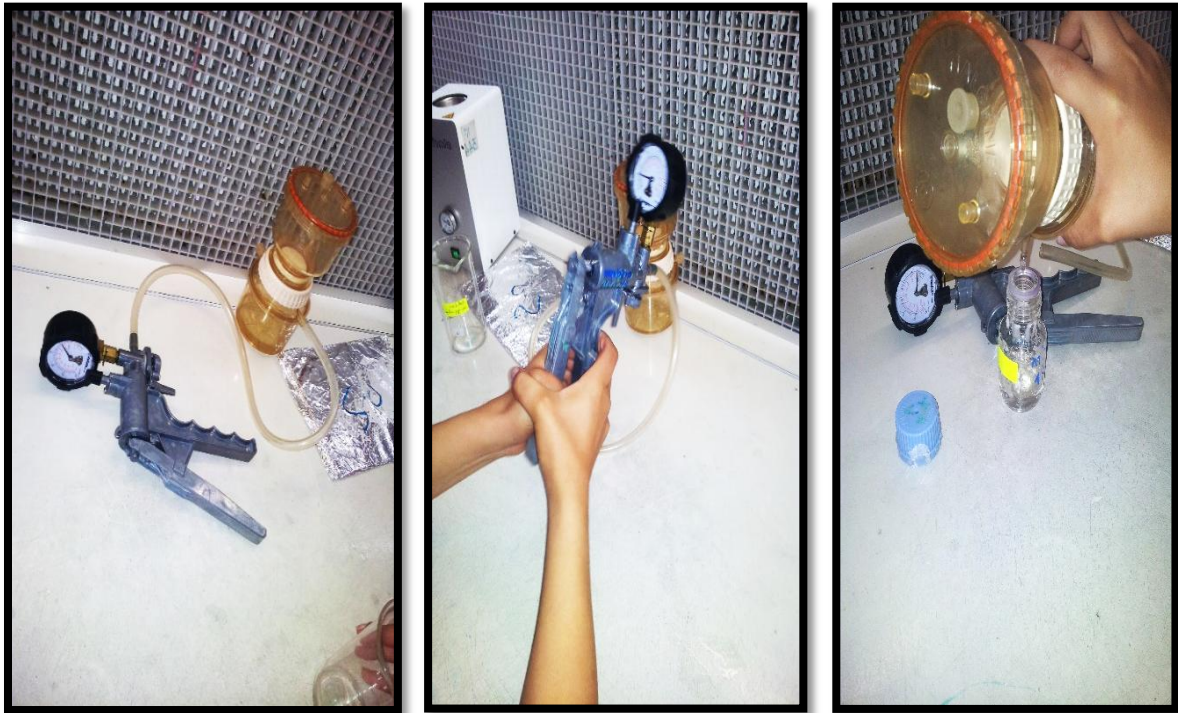
Figure 09: Stérilisation de la solutions enzymatique sous la hotte à l'aide d'une pompe à vide.( Photo personnelle.,2016 )
