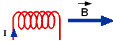
Figure 1.2. Représente le champ magnétique dans une seule bobine.
