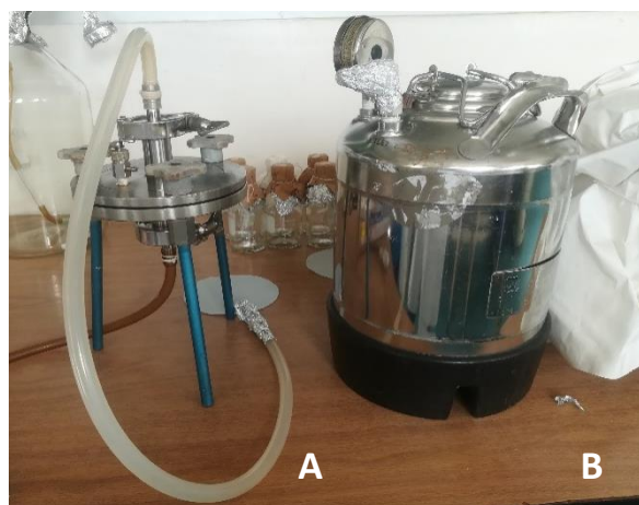
Figure 11 : Photo d'une cuve en inox liée au support de filtration ( Original, 2019 ).
