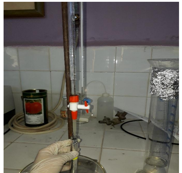
Figure 13 : ajout de l'acétone à 95% dans les tubes contenant 0.1g de feuilles (photo originale, 2019).
